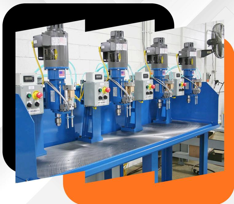
La automatización del perforado y roscado de **Hypneumat** ofrece una solución robusta, precisa y flexible diseñada para integrarse sin complicaciones en líneas de producción industriales. Sus sistemas neumáticos modulares permiten un control exacto de fuerza y velocidad, asegurando calidad uniforme en cada operación y prolongando la vida útil de las herramientas al evitar sobrecargas y desgaste prematuro.
